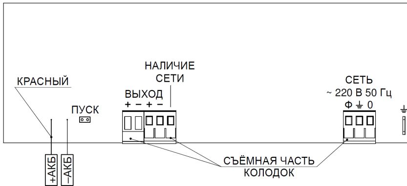
Рисунок 2 - общий вид платы
