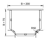
Т-образная секция для всех типов кабельных лотков с высотой боковой стенки 60 мм.
