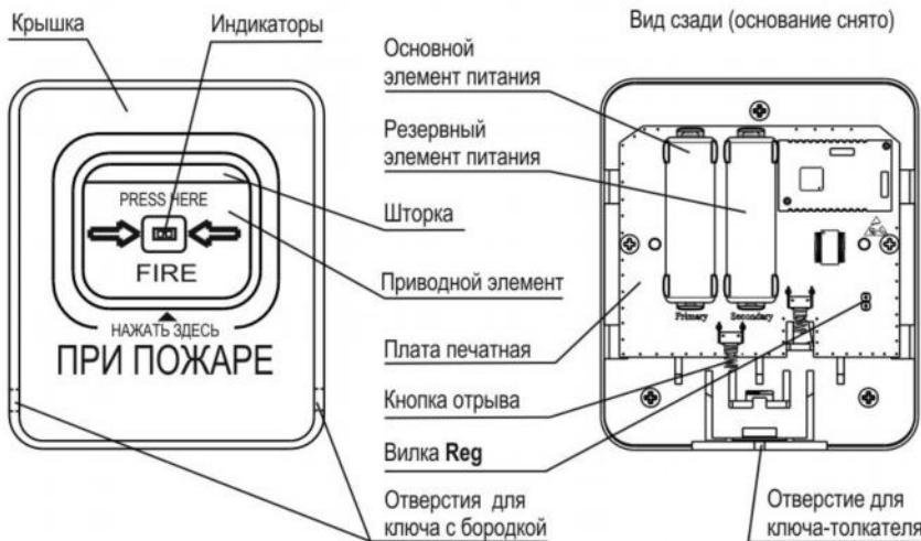
Вилка **Reg** служит для включения на извещателе режима регистрации в радиосети. Для этого выполняется кратковременное замыкание вилки (на 1 - 2 с) с последующим нажатием кнопки отрыва (ТМП). Режим будет включен на время 60 с от момента замыкания вилки. При нормальной работе в радиосети режим регистрации не включается без специальных мер (см. раздел **Настройка системы Астра-Зитадель**)
