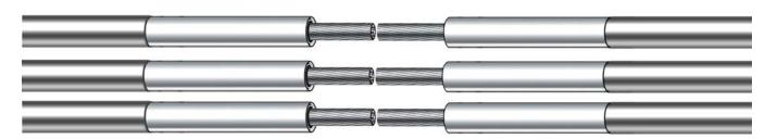
С конца каждой жилы снять изоляцию на длине равной половине длины гильзы. Притупить напильником торцы жил. Опилки удалить.
