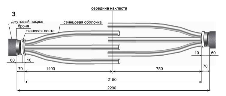
Удалить защитный покров кабеля и бронелент в соответствии с указанными на рис.3 размерами. Свинцовую оболочку зачистить и обезжирить.
