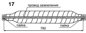
Наложить на фольгу провод заземления. Закрепить эго бандажом из медной проволоки на свинцовой оболочке и припаять.
