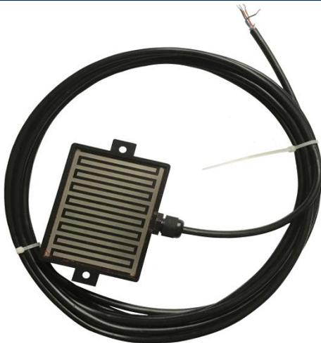
Датчик выполнен в виде прямоугольной пластины с углублением для скопления влаги, с встроенными металлическими пластинами для детектирования влаги и встроенными керамическим подогревателем металлических пластин мощностью 5 Вт. Напряжение питания подогревателя 24 В. Датчик EXTHERM HS в комплект с метеостанцией не входит и поставляется отдельно.
