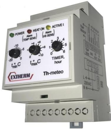
Метеостанция EXTHERM Th-Meteo предназначена для оттаивания и предотвращения образования снежного покрова и льда на различных поверхностях путём включения/выключения нагрузки (греющего кабеля или другого нагревательного элемента) в зависимости от показаний выносного датчика температуры и выносного датчика осадков.
