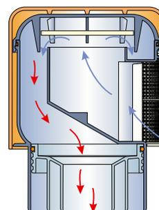
При возникновении разрежения в стояке (более 5 мм вод. столба) клапан открывается и пропускает воздух в стояк, а при выравнивании давления снова закрывается.
