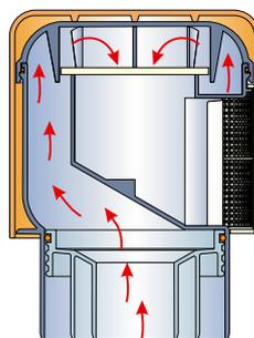
Когда давление в стояке равно или больше атмосферного, клапан закрыт, и канализационные газы из канализации не могут попасть в помещение.
