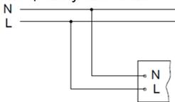
2. Шамдалдың резервтік қуаттандыру блогы бар қуаттандыру желісіне қосылу сызбасы (суретте a - шамдал, b - резервтік қуаттандыру блогы).
