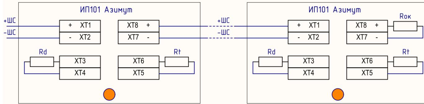
Рок – оконечный резистор, выбирается в соответствии с требованиями ПКП, допускается установка Рок внутри корпуса последнего извещателя в шлейфе;
