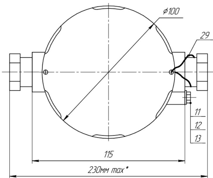
\* зависит от типа кабельного ввода, максимально 230мм.
