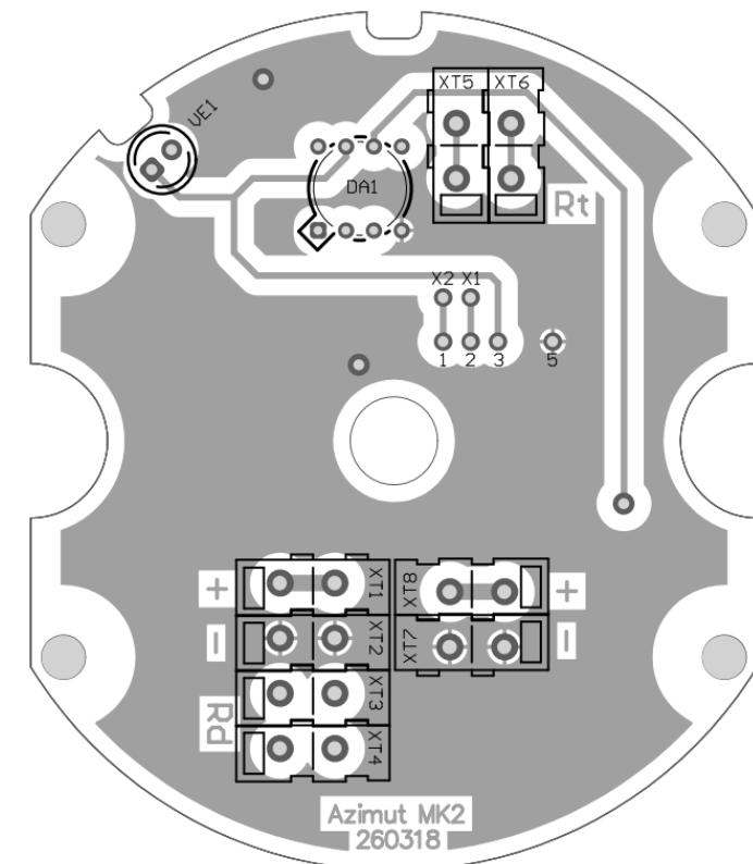
XT1, XT2, XT7, XT8 - клеммы подключения питания;
