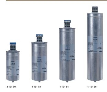
Компактный цилиндрический алюминиевый корпус Пропитка биоразлагаемой полимерной смолой Двойная безопасность: самовосстанавливающийся диэлектрик и защита по избыточному давлению Соответствие регламентам и стандартам: TPTC 004/2011, TPTC 020/2011; MЭК 60831-1, MЭК 60831-2
