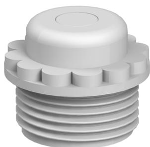
С продавливаемой мембраной, при этом отверстие D предусмотрено, но сначала оно закрыто. Уплотнение для ввода в резьбу Pg согласно DIN 40430. На конце резьбы расположен самоуплотняющийся конус, поэтому уплотнения соединительной резьбы не требуется. Степень защиты IP54.
