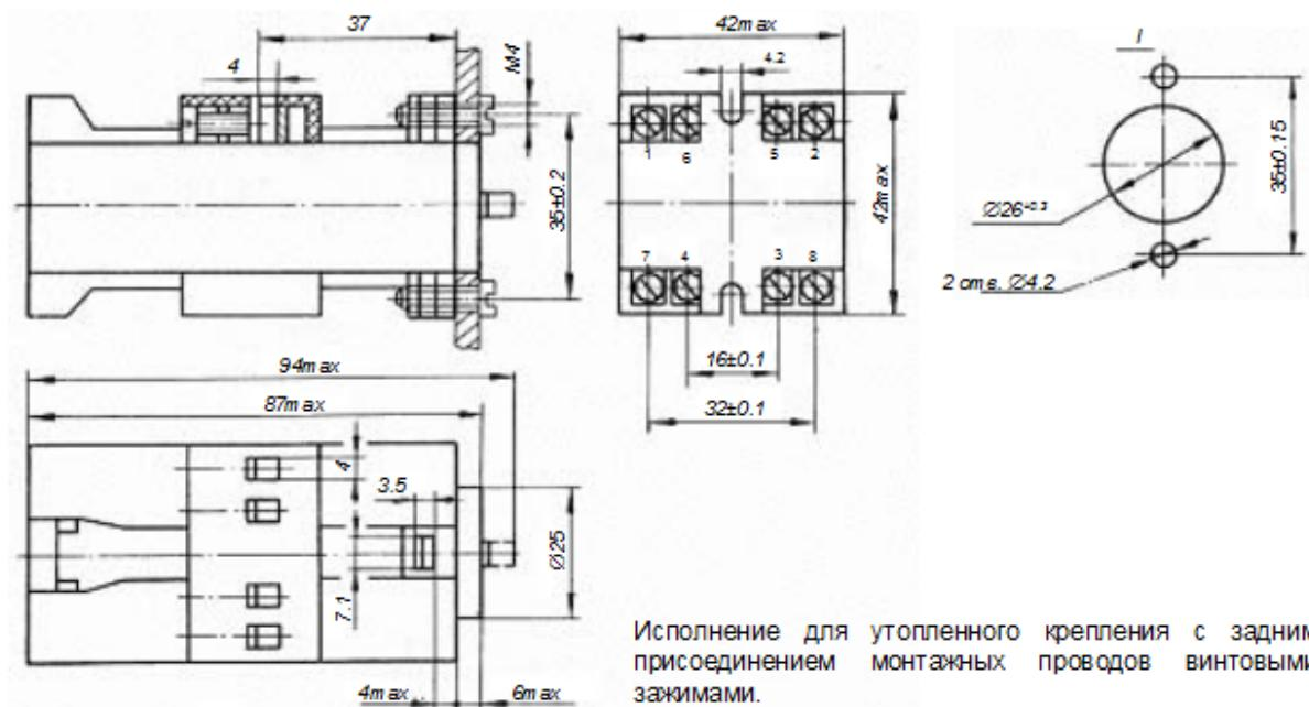
Исполнение для утопленного крепления с задним присоединением монтажных проводов винтовыми зажимами.
