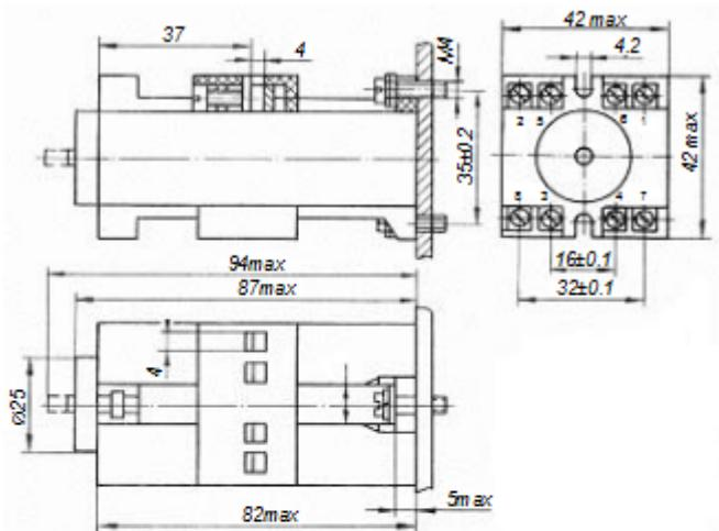
Исполнение для выступающего крепления с передним присоединением монтажных проводов винтовыми зажимами.
