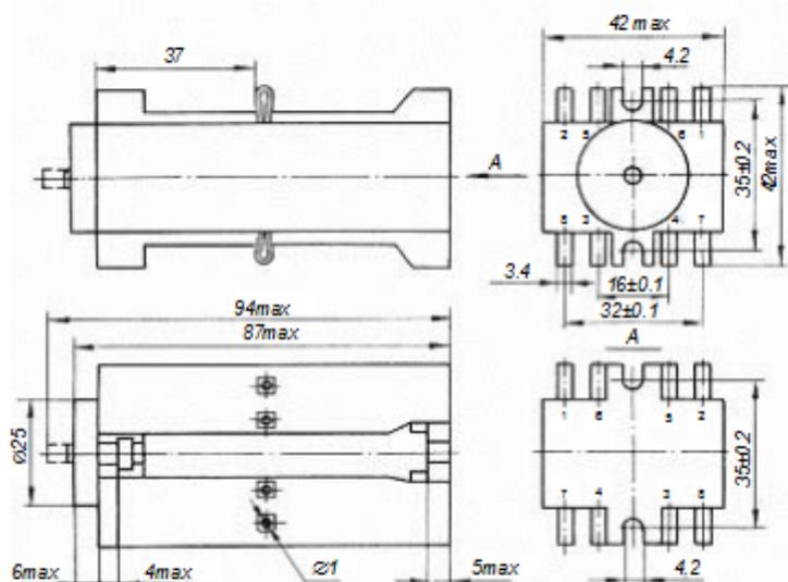
Исполнение для выступающего или утопленного крепления с передним или задним присоединением монтажных проводов пайкой:
