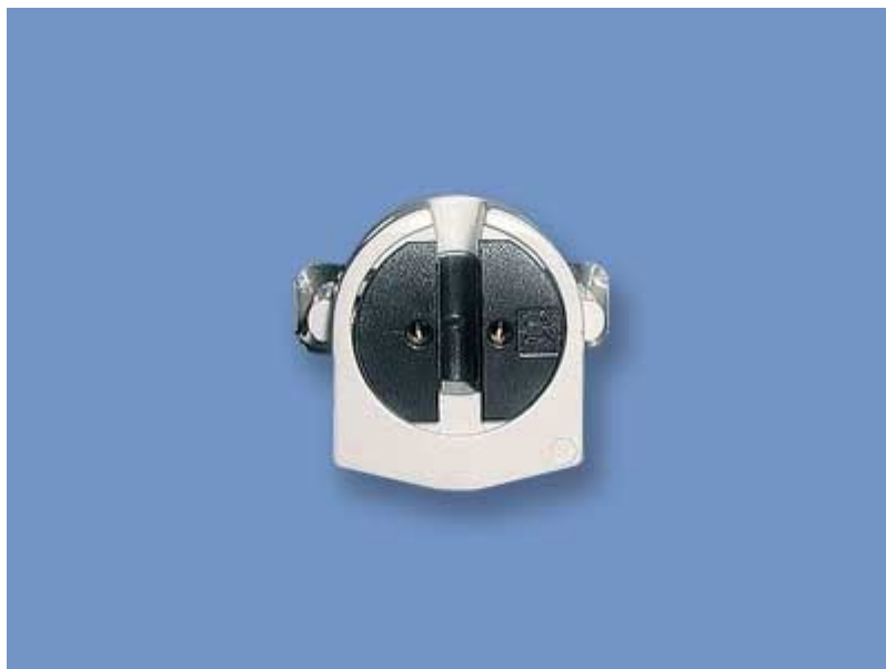
Патрон (лаподержатель) G5 торцевой, встраиваемый в 9,4мм для люминесцентной лампы T5, с пружиной (крепление на цапфы)
