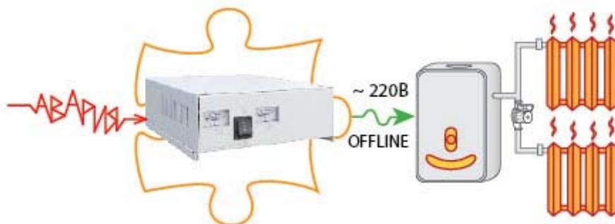
Источник предназначен для непрерывного электроснабжения котлов индивидуального отопления с автозапуском, оснащенных циркуляционными электронасосами, он обеспечит ваше отопительное оборудование качественным электропитанием, защитит его от сетевых неполадок и предотвратит выход оборудования из строя.
