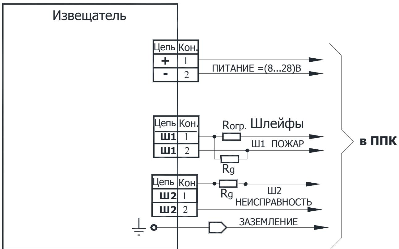
Рисунок 1 Схема подключения извещателя двумя шлейфами сигнализации с питанием шлейфов постоянным напряжением. Полярность шлейфов не соблюдается.
