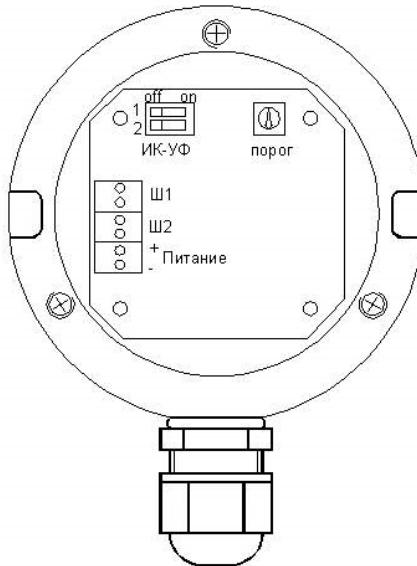
Рисунок 2 Расположение элементов на плате.
