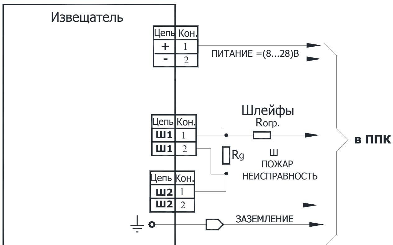
Рисунок 2 Схема подключения извещателя одним шлейфом сигнализации с питанием шлейфа постоянным напряжением. Полярность шлейфов не соблюдается. Оконечный резистор  $R_g$  и ограничительные резисторы  $R_{огр.}$  устанавливаются в соответствии с документацией на ППК.
