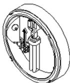
7. Встановити на місце розсіювач та верхню частину світильника і зафіксувати їх, затягнувши 4 гвинта.
