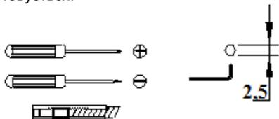
2. Зняти верхню частину світильника та розсіювач, використовуючи шестигранний ключ №2,5.
