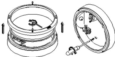
3. Гермекірістердің біреуі арқылы шамшырақтың негізіне көлденең қималы (диаметрі 6,5 мм аспайтын) желілік кабельді (ұзындығы кем дегенде 180 мм) енгізу керек. Желілік кабельді кезекпен үш саңылау арқылы өткізу керек.
