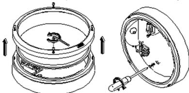
3. Через один из гермовводов завести в основание светильника сетевой кабель (длиной не менее 180 мм) круглого сечения (диаметр не более 6,5 мм). Продеть сетевой кабель поочередно через три отверстия пластины, защищающей кабель от выдергивания.
