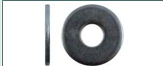
Оцинкованная. Рекомендуется для использования совместно с болтами, винтами и другими крепежными элементами. Применяется для уменьшения давления на опорную поверхность. Используется при работе с тонколистовыми материалами. Наружный диаметр шайбы приблизительно равен трем внутренним диаметрам.
