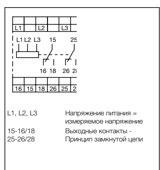
Схема подключения CM-MPN.x2
