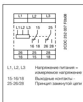
Схема подключения CM-PAS.x1
