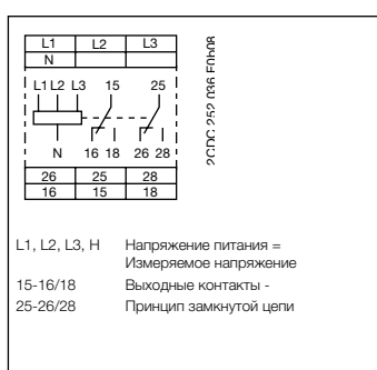
Схема подключения CM-UFS.2
