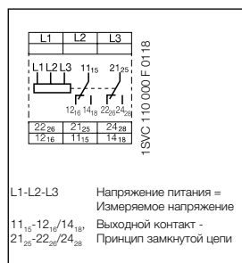
Назначение поворотного переключателя CM-PVS
