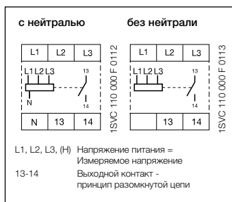
Схема подключения CM-PBE
