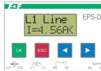
Рис. 5: Панель управления EPS-D
