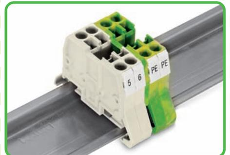
Для выполнения требований по утечке и зазору для задач Ex e, необходимо вставить торцевую или промежуточную пластину между проходной клеммой и клеммой с заземлением. Торцевые пластины 870-923 (серые), 870-924 (оранжевые) и 870-925 (светло-серые), а также разделительные пластины 870-928 (серые) и 870-929 (оранжевые) не могут быть установлены вместе с 2-проводными клеммами с заземлением класса Ex 870-907/999-950.
