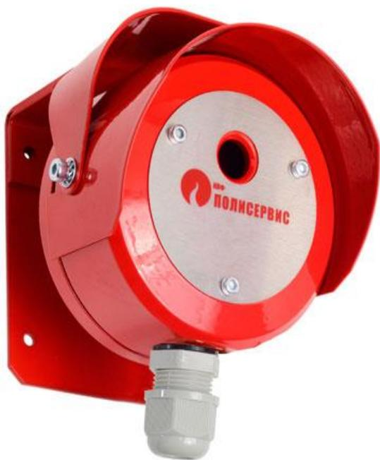
Извещатель пожарный пламени Тюльпан 2-18 предназначен для обнаружения электроизлучения пламени в ультрафиолетовом диапазоне с максимумом спектральной чувствительности  $\lambda=200$  нм и выдачи извещения о пожаре.
