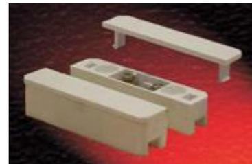
Извещатель каждого исполнения конструктивно состоит из датчика магнитоуправляемого (датчика) на основе геркона имеющего нормально-замкнутые контакты и задающего элемента (магнита), выполненных в пластмассовых корпусах. Крепежные отверстия извещателя сверху закрыты накладной декоративной крышкой.
