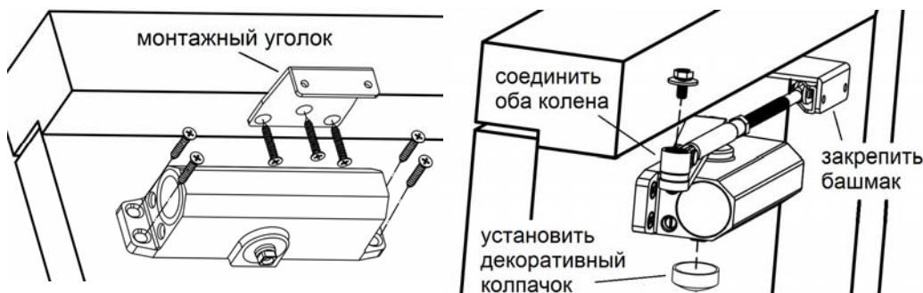
Рисунок 5 – Вариант параллельной установки при помощи монтажного уголка
