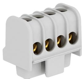
Клеммы из латуни, винты из стали, с гальванической оцинковкой и прозрачным пассивированием, номинальное сечение 6 - 16 мм<sup>2</sup>, номинальное напряжение 400 В, 1-контакт., с разъемами Макс. подключаемые поперечные сечения для каждой клеммы: 4 x 2,5 мм<sup>2</sup>, 5 x 1,5 мм<sup>2</sup> или 6 x 1 мм<sup>2</sup>.
