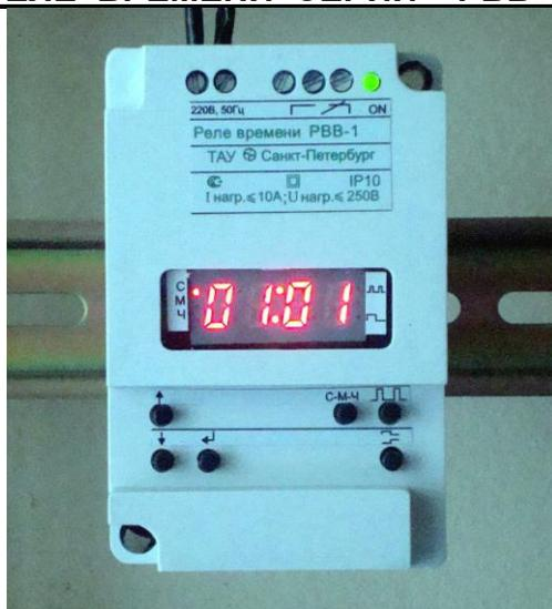
Универсальные реле времени серии «РВВ» (далее - реле) предназначены для коммутации (включения либо отключения) электрической цепи на заданное время. Реле могут использоваться как:
