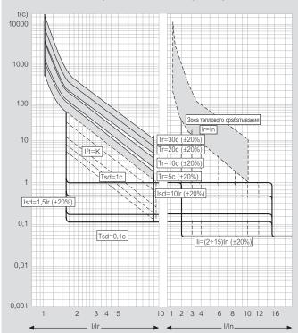
Если ток короткого замыкания больше Icw или ток Ii задан равным Icw, то время срабатывания расцепителя равно 30 мс
