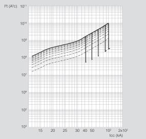
Ісс (КА) = расчетный ток симметричного короткого замыкания
