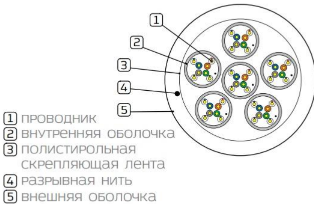
Рисунок 3 – Неэкранированный многопарный кабель U/UTP категории 5е, 24 пары (6 x 4)
