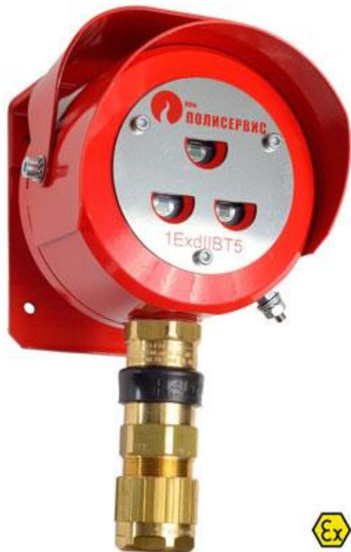
Извещатель пожарной пламени Тюльпан 2-14В предназначен для обнаружения электромагнитного излучения пламени в инфракрасном диапазоне с максимумами спектральной чувствительности на  $\lambda_1=4,4$  мкм и выдачи извещения о пожаре. Оснащен опорными каналами на  $\lambda_2=4,0$  мкм и  $\lambda_3=5,0$  мкм.
