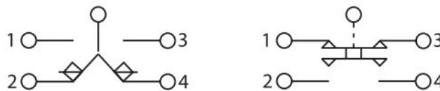
Рисунок 1. Принципиальные электрические схемы путевых выключателей полумгновенного и прямого действия.
