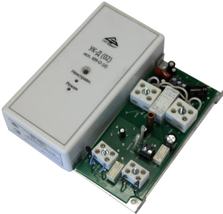
УК-Д (02) включается в диагностируемую линию связи (ЛС) управляющего устройства: устройства контроля линий связи и пуска базового УКЛСиП (Б) или устройства контроля линий связи и пуска релейно-прецизионного УКЛСиП (РП).
