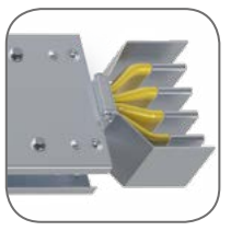
Для уменьшения потерь электроэнергии сечение шин шинопровода увеличено на 10-20%, в зависимости от номинального тока
