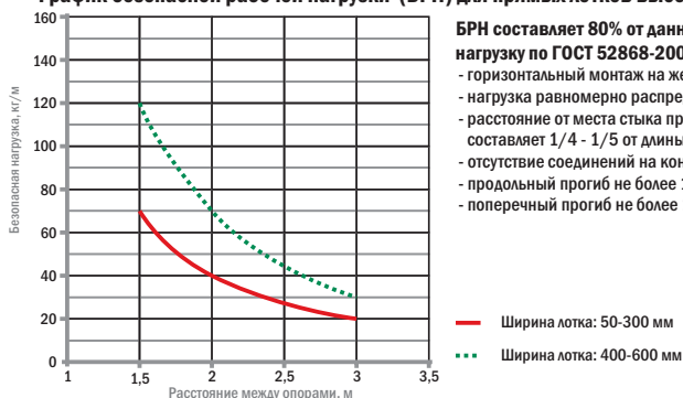
График безопасной рабочей нагрузки (БРН) для прямых лотков высотой 50 мм
