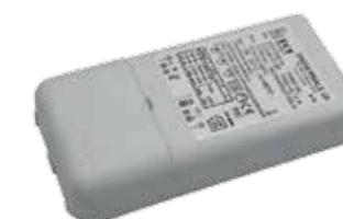
Для работы светодиодных светильников необходимы драйверы постоянного тока. Драйвер следует выбирать исходя из указанных в документации на светильник тока и мощности. Требуется соблюдать полярность при электрическом соединении светильника и драйвера, во избежание выхода светильника из строя. Драйверы для управления по протоколу DALI – TCI DC MINI JOLLY DALI, HELVAR LL1X20-E-DA и HELVAR LC1X30-E-DA. Драйверы для управления по протоколу 1-10V – TCI MINI JOLLY 1-10V 122400.
