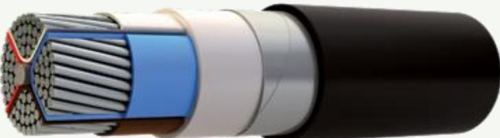
Кабели с ПВХ изоляцией, бронированные, не распространяющие горение, с низким дымо- и газовыделением (LS — Low Smoke), на напряжение до 1 кВ включительно. ТУ 16.К71-310-2001 (Базовые документы – ГОСТ Р 53769-2010, ТУ 16-705.499-2010)
