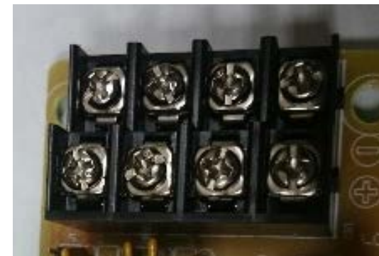
Вид на клеммную колодку (крышка снята)
