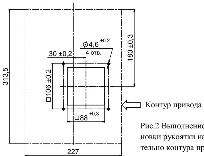
Рис.2 Выполнение отверстий для установки рукоятки на двери НКУ относительно контура привода.
