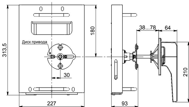
Рис.1 Габаритные размеры ручного дистанционного привода.
