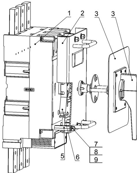
Рис.3 Выносная ручка в сборе с выключателем
