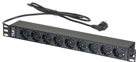
Блок электрических розеток выполнен в виде корпуса с креплением 19" и высотой 1U. Корпус изготовлен из алюминиевого профиля толщиной 1,2 мм, все элементы блока розеток имеют единый контур заземления. Использование корпуса из алюминиевого профиля обеспечивает дополнительную защиту от повреждения при случайных ударах, более высокую термостойкость, облегченную конструкцию, улучшенное охлаждение и дополнительное экранирование от электрических помех.
