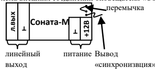
Рисунок – 1 Схема внешних соединений оповещателя «СОНАТА-М МИНИ»
