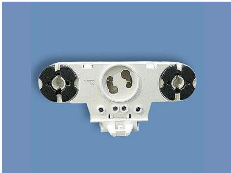
Патрон (ламподдержатель) сдвоенный G13, вставной T-образный h-оси 26mm, со стопором, для T8, T12 люминесцентных ламп, со стартеродержателем (крепление на боковые защелки)
