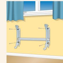
Закрепите кронштейн на стене с соблюдением требований инструкции: расстояние от пола до нижнего края конвектора должно быть не менее 10 см.
