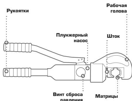
В процессе достижения максимально-го рабочего давления возникает встречная нагрузка и срабатывает клапан автоматического сброса давления (АСД)
