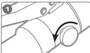
**Поверните винт сброса давления в положение «Открыть».**
