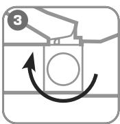
**Поверните винт сброса давления в положение «Закрыть»**
