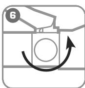
**Для сброса давления поверните винт сброса давления в положение «Открыть»**
