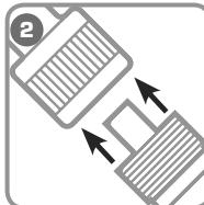
**Присоедините рукав высокого давления (РВД) помпы к клапану гидравлического инструмента**
