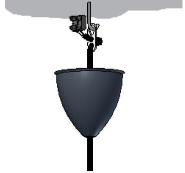
3 Потолочную чашку поднять до упора к поверхности потолка. Вставить лампу.
