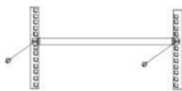
19" монтаж в шкафу
