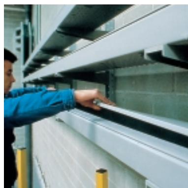
Крышка надевается с нажимом, без болтов и скоб
