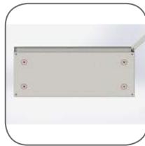
15. При необходимости установки шкафа на пол необходимо закрепить его на цоколе. Для этого нужно просверлить 4 отверстия Ø7 в местах кернения в крышке нижней
