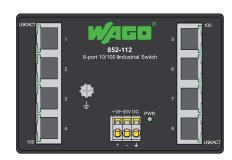
852-112 оснащен 8 портами, каждый из которых имеет функцию автосогласования и автоопределения MDI/MDIX. Существующие сети со скоростью 10 Мбит/с теперь могут быть без усилий модернизированы до сетей Fast ETHERNET со скоростью 100 Мбит/с.
