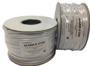
Слаботочный кабель ALARM и ALARM-S состоит из 7 скрученных проводников, площадью сечения 0,22 мм<sup>2</sup>, что придает кабелю большую гибкость и пластичность, чем у кабелей с моножилкой.
