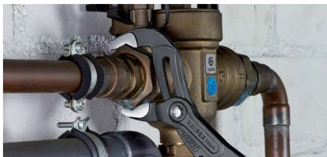
Смещенные против направления зубцы обеспечивают эффект самофиксации и предотвращают соскальзывание инструмента с детали.
