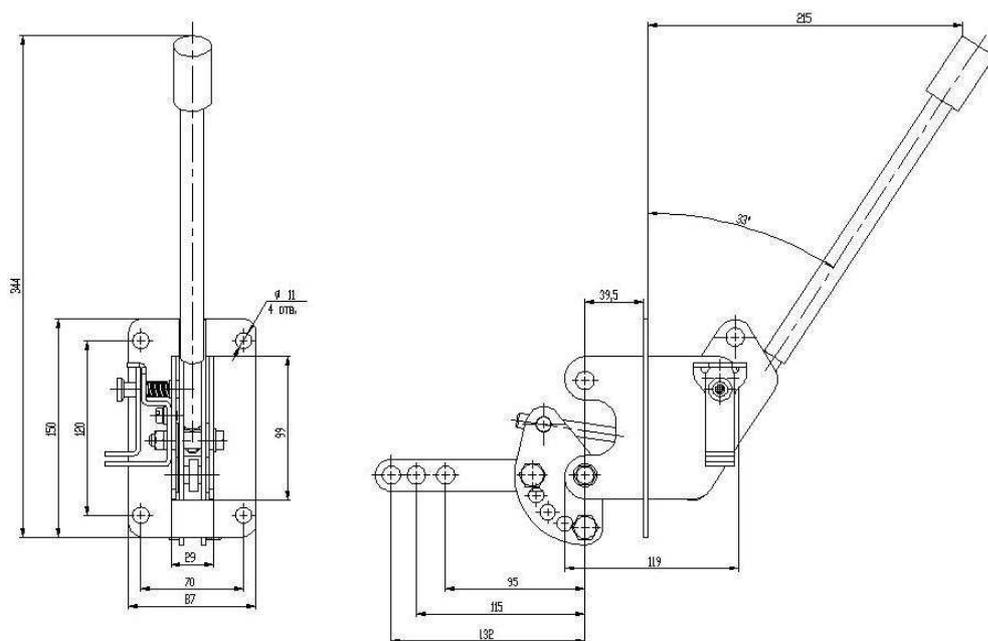
**Габаритные и присоединительные размеры привода ПР-10 Б ВН**
