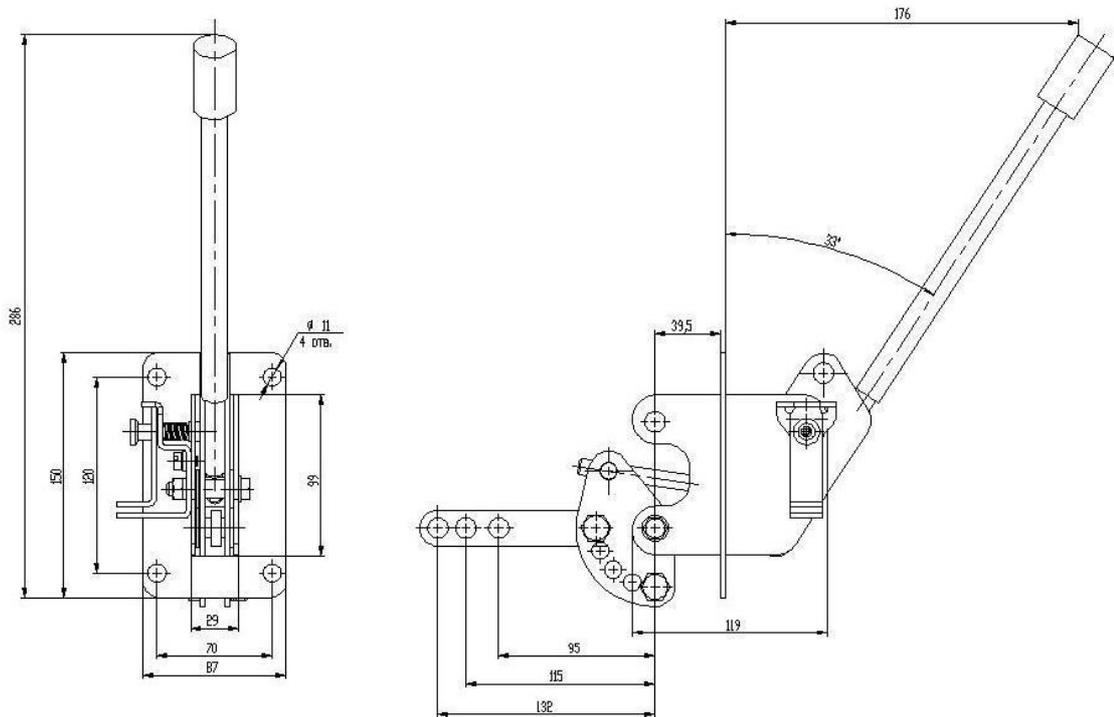
**Габаритные и присоединительные размеры привода ПР-10 Б**
