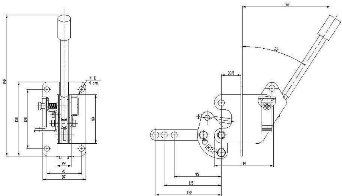
**Габаритные и присоединительные размеры привода ПР-10 Б ЗБ-1М**
