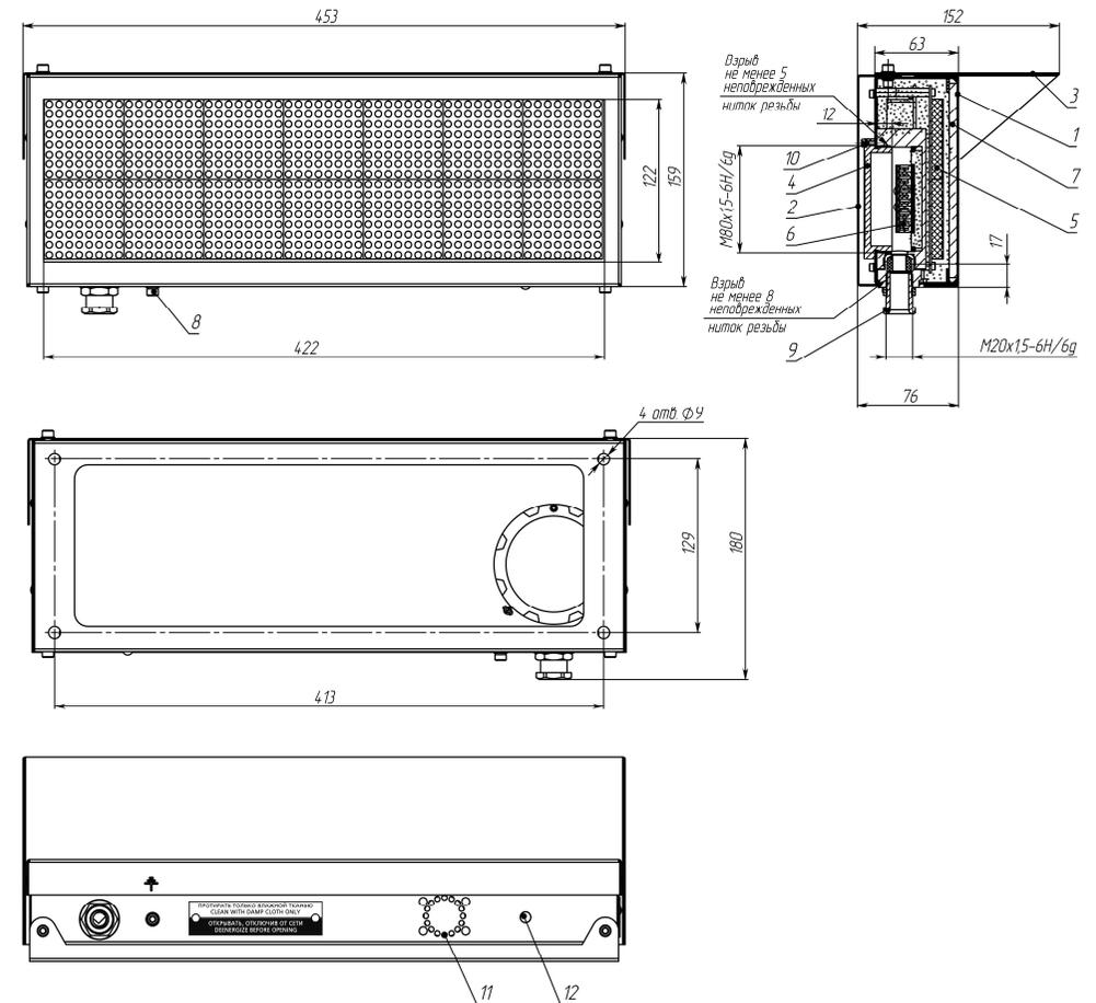
1 – корпус; 2 – кронштейн; 3 – козырек; 4 – клеммная коробка; 5 – плата индикации; 6 – плата клемм; 7 – стекло; 8 – винт заземления; 9 – кабельный ввод (показан для примера); 10 – стопорный винт; 11 – пьезосирена; 12 – индикатор режимов работы оповещателя.
