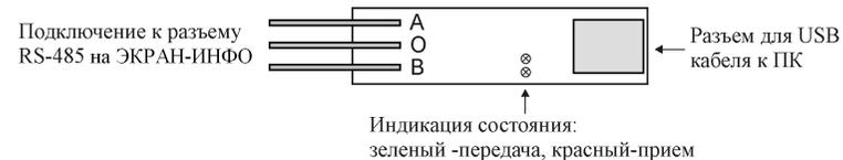
**Рисунок 6.** Расположение контактов преобразователя ПИ1.
