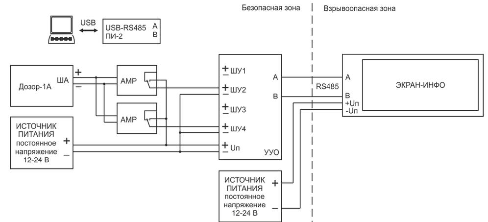
**Рисунок 13.** Пример подключения оповещателя ЭКРАН-ИНФО-RGB в адресный шлейф прибора Дозор-1А через адресные метки реле АМР и устройство управления УЮ-RGB.
