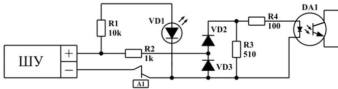
**Рисунок 10.** Схема каскада входа управления ШУ УЮ-RGB
