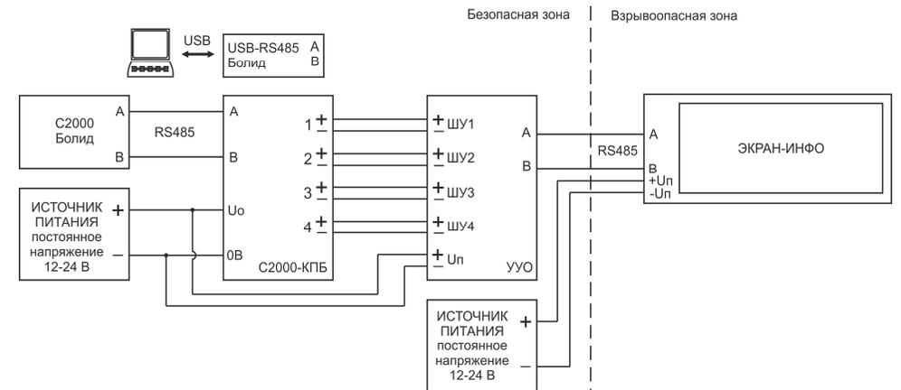
**Рисунок 14.** Пример подключения оповещателя ЭКРАН-ИНФО-RGB к блоку контрольно-пусковому С2000-КПБ через устройство управления УЮ-RGB.
