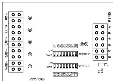
**Uп** – клеммы напряжения питания 12-24VDC;
